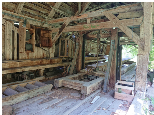
Abb. 6 Sägeraum im Obergeschoss mit Sägegatter, Joch und Klotzwagen
