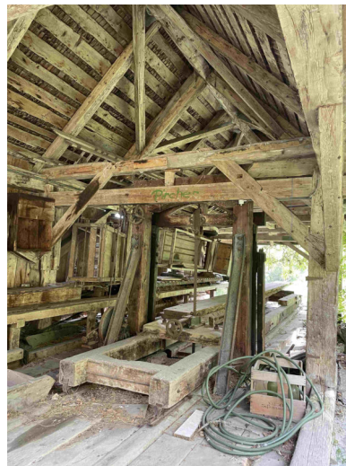
Sägeraum im Obergeschoss mit Sägegatter mit Joch und Klotzwagen Foto DPG 2021
